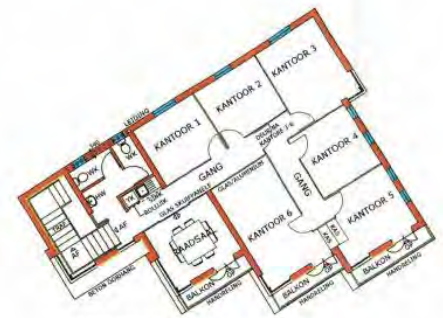
EERSTEVLOER SKAAL 1:100 BUITE OPPERVLAKE - 138 M 2 - 8000 KLEI STEEN STAAL EN HOUT TRAP KANTOOR 1 EN 2 WORD AFAPART VERHUUR EN DEEL TOILETTE, KOKKEKUIS EN RAADSZAAL HET KANTOOR 3 TOT 6
