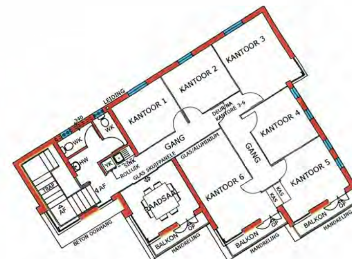
EERSTEVLOER SKAAL 1:100 BUITE OPPERVLAKE - 138 M 2 - ROOI KLEI SIERSTEEN STAAL EN HOUT TRAP KANTORE 1 EN 2 WORD APART VERHUUR EN DEEL TOILETTE, KOMBUIS EN RAADSAA MET KANTORE 3 TOT 6
