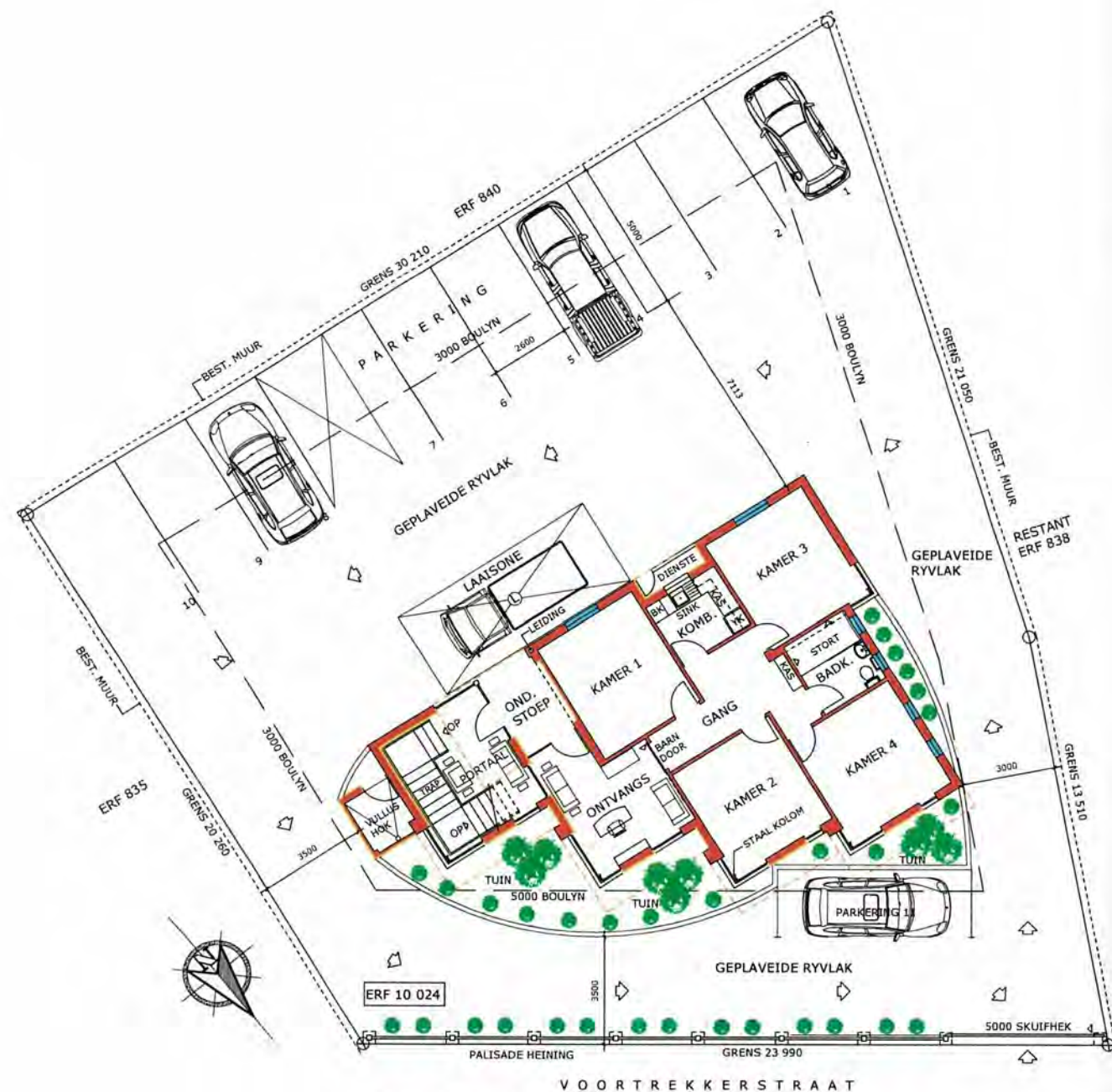
GROND - EN TERREINPLAN SKAAL 1:100 BUITE OPPERVLAKE - 138 M 2 - ROOI KLEI SIERSTEEN STAAL EN HOUT TRAP
